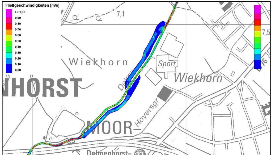
Abbildung 4-2: Strömungsgeschwindigkeiten bei BHQ
