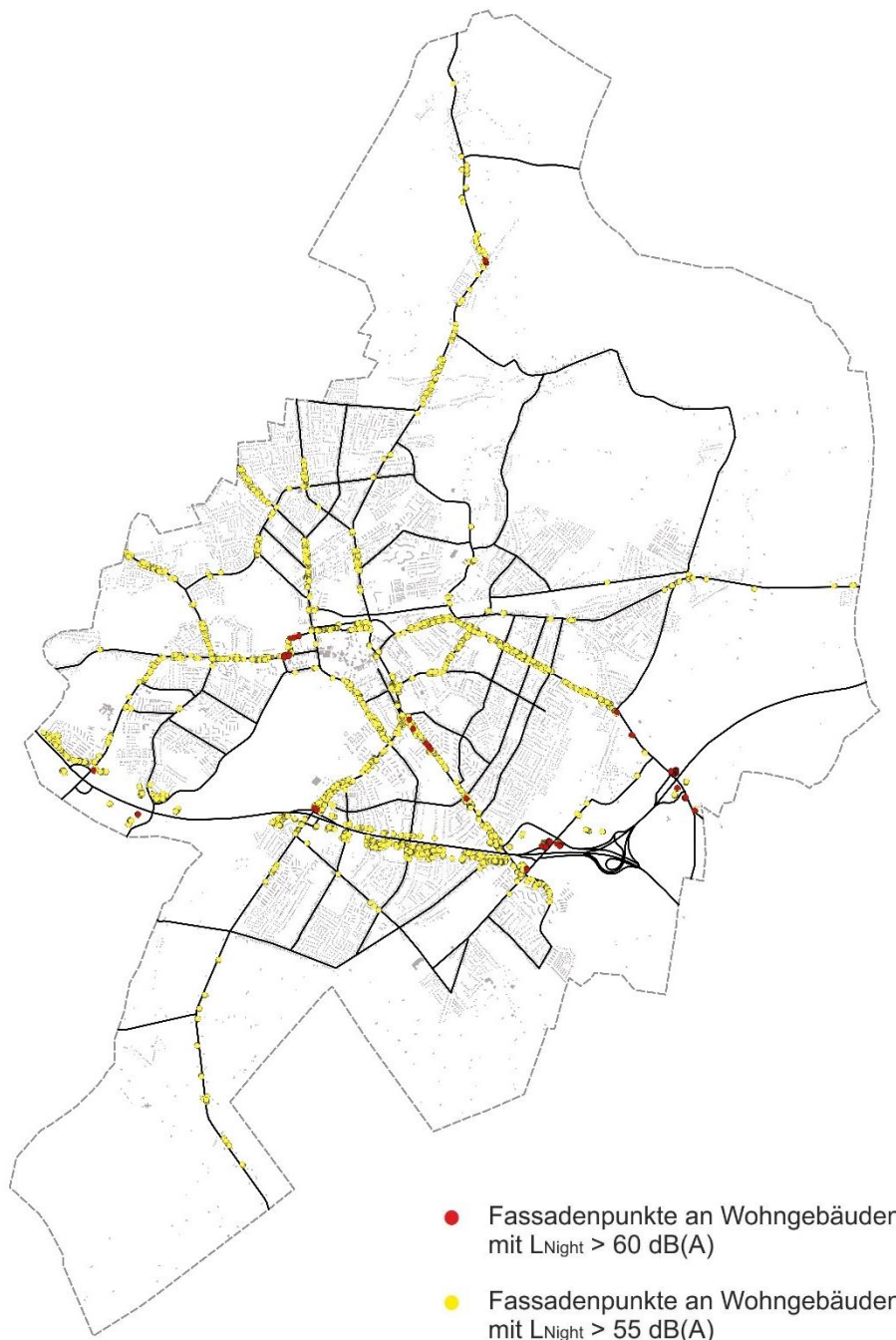
Abbildung 27: Empfehlungen für passiven Schallschutz, Überschreitung der Auslösewerte durch Straßenverkehrslärm an Wohnhäusern nach Umsetzung der empfohlenen Maßnahmen
